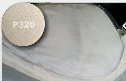
Ponçage avec abrasif **A23Y grain P320**. Nettoyer avec le **microfibre bleu** ou air comprimé après le ponçage.
