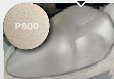
Cette étape représente l'opération de finition du polycarbonate de la phase 1, ou l'élimination du vernis abîmé. Il est donc très important de déplacer la ponceuse **sans pression** sur toute la surface de l'optique afin d'éviter tout risque de rayures.
