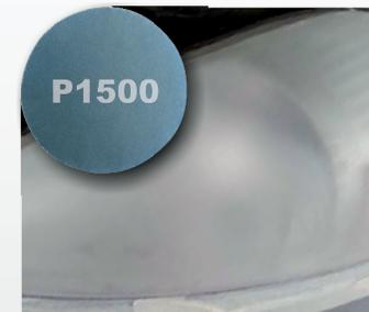
Polissage avec **WS grain P1500**.
