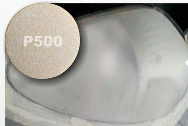
Ponçage avec abrasif sur interface mousse **A23Y grain P500**...
