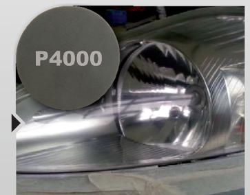
Pour obtenir une vitesse suffisante en phase de polissage final, soulever et incliner légèrement la ponceuse. Pour une plus haute brillance, faire un deuxième passage avec le même disque et la **pâte à polir Fine Cut LP110**. Essuyer avec le **microfibre rouge**.
