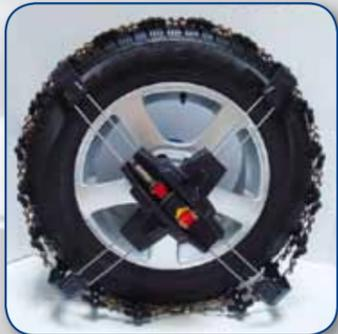
2. Mettez la chaîne à neige sur le pneu et faites glisser le rail de montage sur le porte "EASY FIX" permanent.
