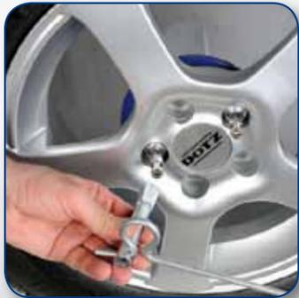
1. Montez le porte "EASY FIX" permanent sur deux écrous de votre jante. Cela permet un montage de la chaîne à neige en quelques secondes sur les pneus en cas de neige ou de verglas.
