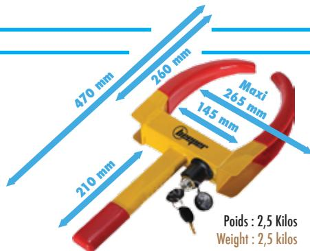
\* Cet antivol dispose de plusieurs niveaux de verrouillage, permettant ainsi de s'adapter à toutes les roues. La largeur maximale de la roue ne doit pas dépasser 265 mm. Cette dimension est indiquée sur vos pneus, par exemple un pneu ayant un code 185/60R15 aura une largeur de 185 mm. Il n'y a pas de largeur minimale.
