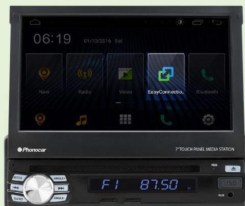
L'APP EasyConnection permet de connecter le smartphone à la médiastation pour utiliser les principales fonctions en sécurité pendant la conduite.
