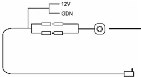
Caméra de recul à installer à l'arrière du véhicule.
